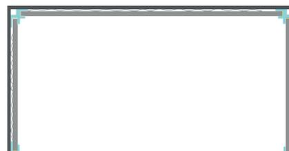
Les panneaux sont maintenant prêts pour fixer une porte de douche si nécessaire. Veuillez fixer les panneaux au mur avec un adhésif à haute adhérence pour une fixation sécurisée.
