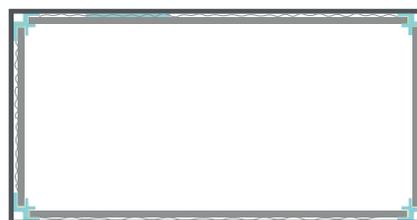
10. Le panneau de dessus de porte doit être coupé précisément. De chaque côté du panneau, un joint de silicone doit être appliqué.
