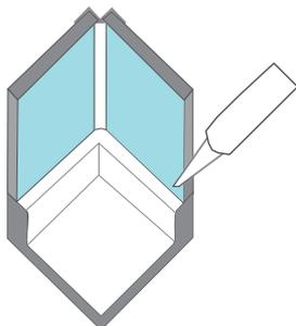
Multipanel® Seal est un kit tout-en-un pour sceller le bas du panneau Multipanel® sur un receveur de douche ou une baignoire. Voir le guide d'installation séparé.
