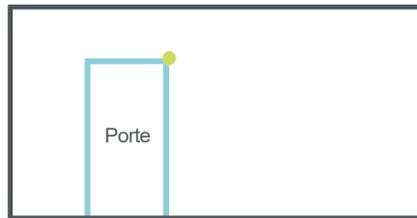
1. Commencez par le côté de la porte, en travaillant dans le sens des aiguilles d'une montre en s'éloignant de la porte.
