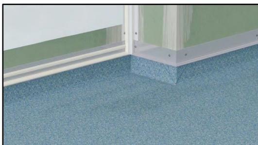
Dans les zones humides, telles que les salles d'eau, nous recommandons l'utilisation d'un profilé en aluminium de type X.
