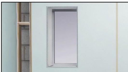
Pour les contours de fenêtre, un profilé de type E doit être utilisé entre les panneaux et pour les coins, des coupes d'angle seront nécessaires.
