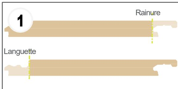
Les panneaux Hydrolock® sont fournis en général avec un bord à languette et un bord à rainure. Lors de l'installation d'un profilé le long d'un panneau, le bord à rainure ou à languette doit être coupé pour permettre de l'insérer.
